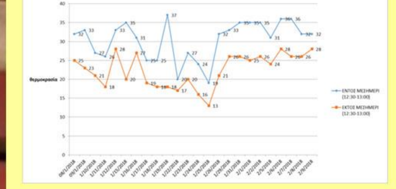
Σύγκριση θερμοκρασιών εντός και εκτός θερμοκηπίου το μεσημέρι
